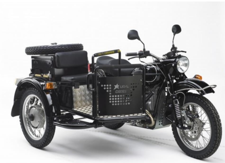
Infatti subito dopo è entrato in produzione sia il modello completo sia il Kit separato, capace di trasformare una Ural standard in una versione più leggera, con barchino dotato solo di piattaforma, barre e attacchi. Il sidecar completo con due ruote motrici, costa 28.000 euro .
