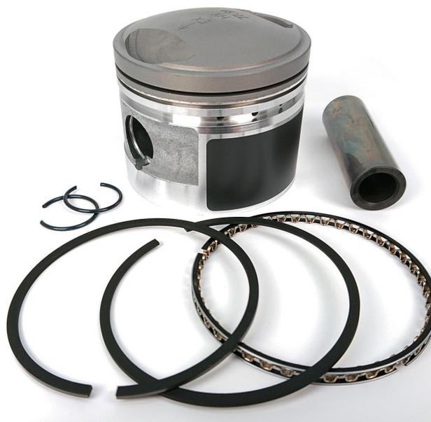
**Pistoni:** ora viene effettuato un nuovo insieme di trattamenti termici atti al miglioramento delle caratteristiche meccaniche delle leghe di alluminio e silicio; le fasce elastiche sono ora rivestite al fosfato di manganese consentendo una precisione finale con tolleranze ottimali della scanalatura del segmento dei pistoni. Quindi abbiamo nel complesso una lavorazione del pistone ad alta precisione che consente una misura del cilindro, non più diviso in tre classificazioni.
