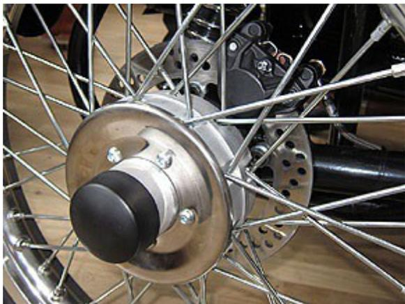
Come potete notare in questo bel disegno, il freno posteriore della moto ha anche un dispositivo per il freno di stazionamento comunemente detto freno a mano.
