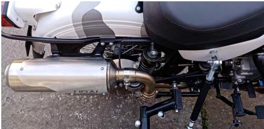
L'impianto è costituito ora da un sistema 2 in 1 con silenziatore montato un po' in alto con valvola di scarico, 2 set di catalizzatori con precatalizzatori situati nel collettore di scarico; ora abbiamo una rumorosità ridotta e, come detto, una maggiore altezza da terra, molto indicata per un utilizzo anche fuoristradistico.
