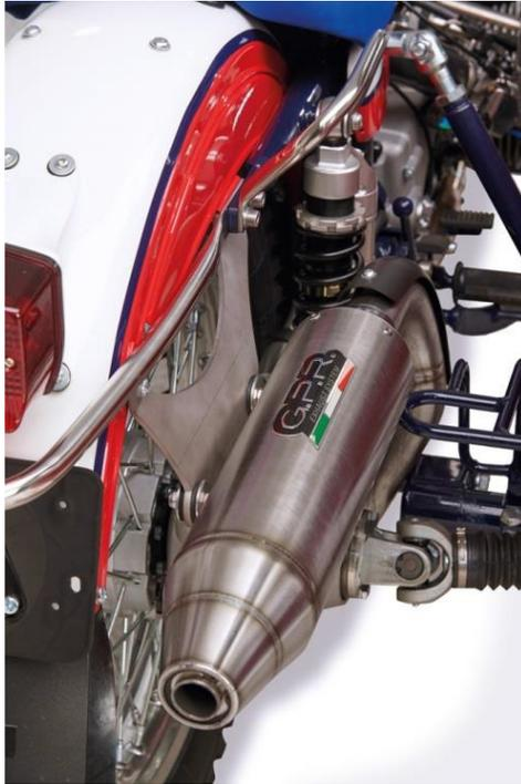
Il secondo fulcro della URAL ADVENTURE sono gli ammortizzatori HCS; La compressione e la trazione di questi ammortizzatori sono completamente regolabili. Il serbatoio è ruotabile di 360 gradi. La regolazione ideale degli ammortizzatori varia per la ruota posteriore, la ruota anteriore e la ruota laterale del barchino. Ci sono due chiavi per la regolazione del precarico della molla, una piccola e una grande. Sono ammortizzatori ad alte prestazioni: una URAL ne ha bisogno di cinque.
