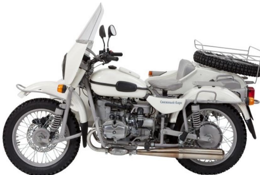
La versione Leopard è pressocchè identica al modello Ranger da cui nasce, in quanto è una combinazione attrezzata per l'inverno. Può essere montato sia con tre pneumatici invernali tassellati Heidenau o standard. Ha le manopole termiche e un parabrezza per il conducente. Il sidecar è dotato di pala, tanica, portapacchi, luce frontale supplementare, paraurti anteriore e una ruota di scorta.
